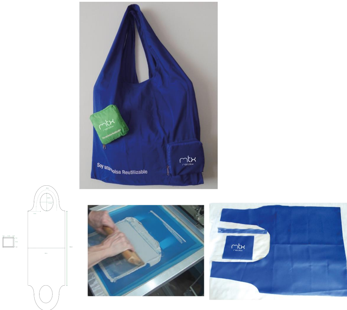
Figura 30. Maquetación, armado, impresión y producto final del bolso Soy una bolsa reutilizable. Fuente: Natali Morán
