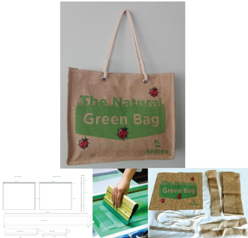
Figura 29. Maquetación, armado, impresión y producto final del bolso de yute. Fuente: Natali Morán
