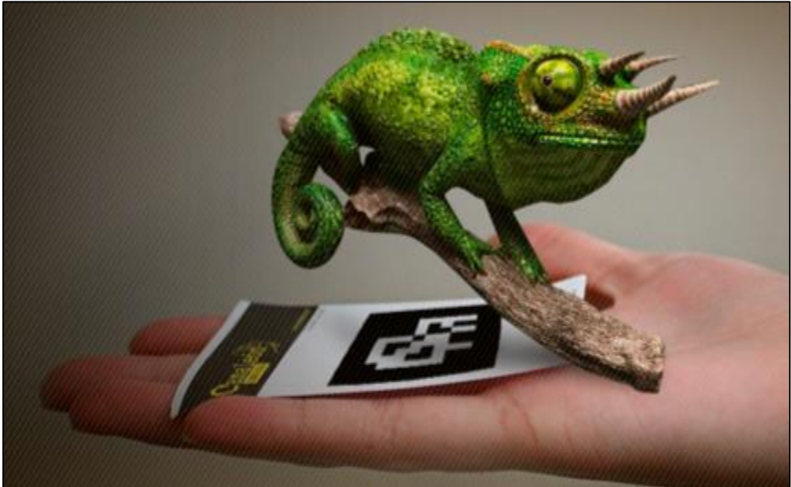
Figura 4: Marcador de RA, está representado por la impresión en papel debajo del camaleón
