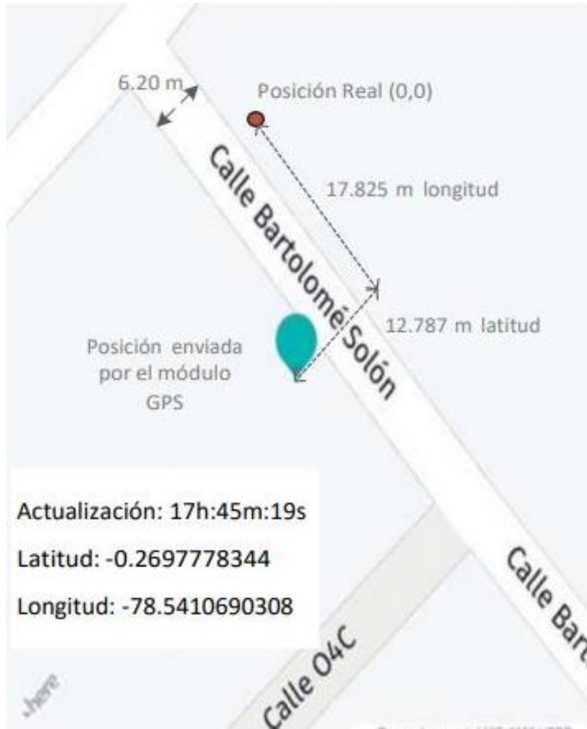
Valenzuela, M. (2023). Figura 17: Distancia de ubicación real vs ubicación de GPS Arduino.
