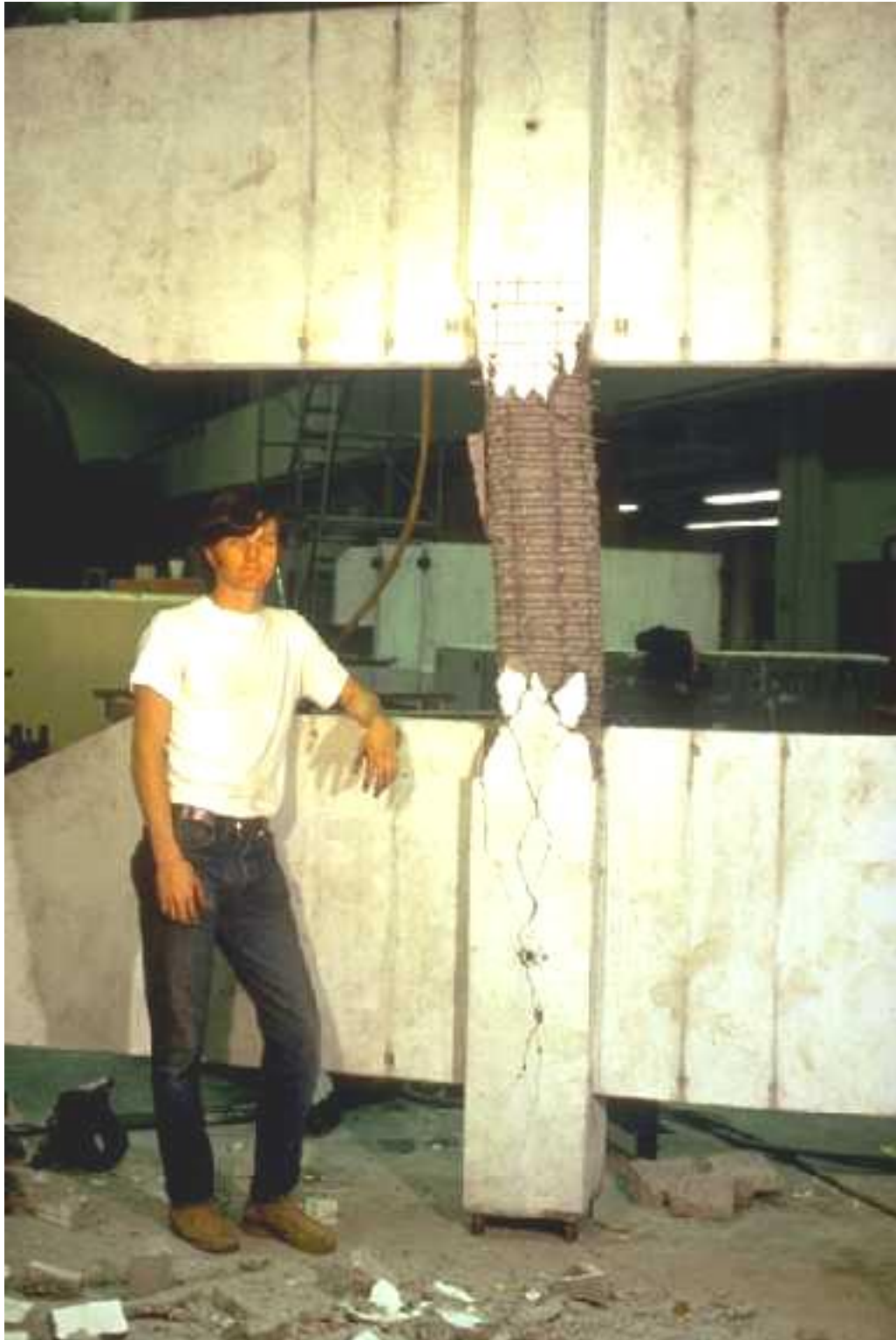
Foto 5.2: Ensayo de una columna.
