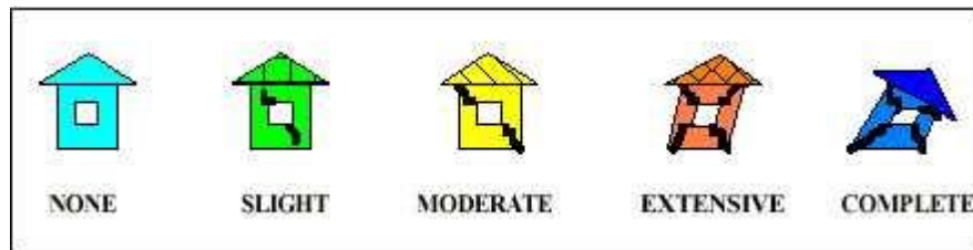
Figura 4.28: Los cinco estados de daño.
