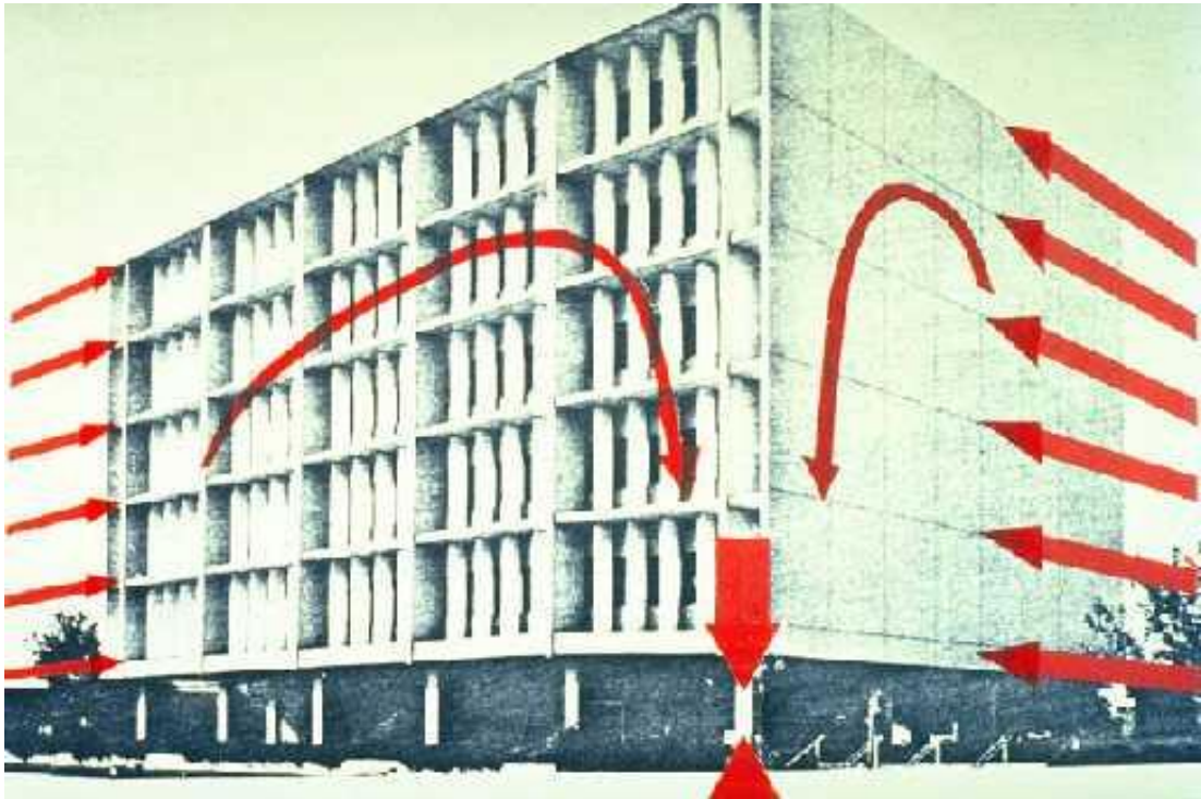
Foto 7.7: Edificio con daño en la columna esquinera (representación de fuerzas sísmicas).
