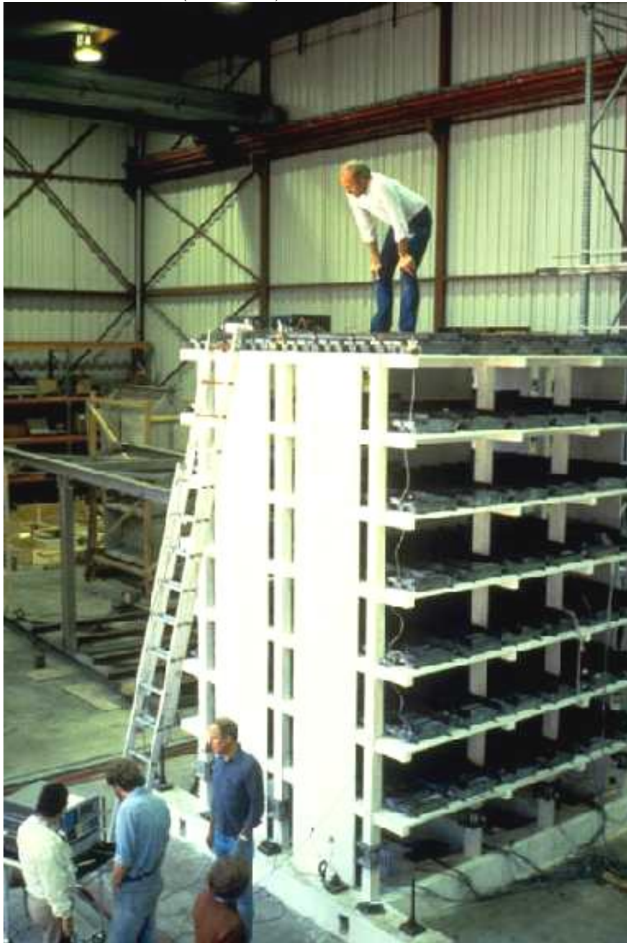
Foto 5.5: Edificio construido a escala para ser ensayado en laboratorio.
