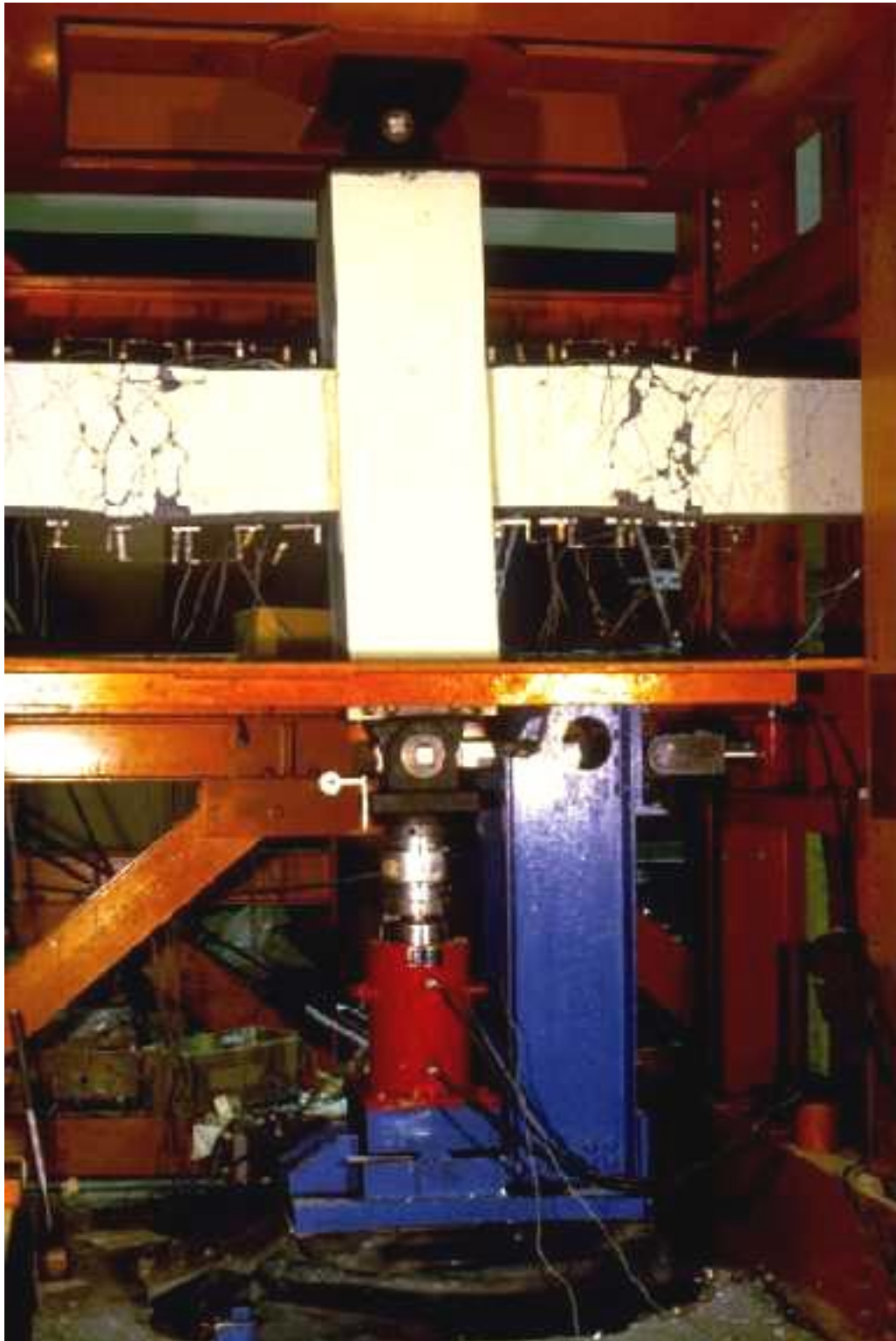
Foto 5.3: Ensayo en laboratorio viga-columna.
