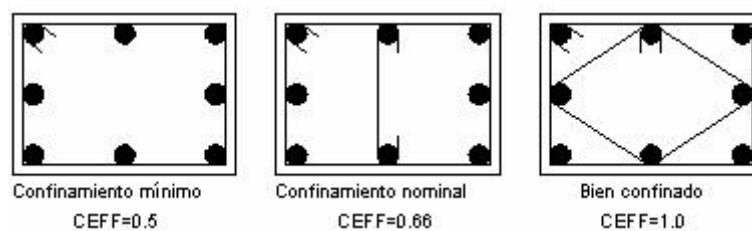
Figura 5.4: Diferentes formas de confinamiento de una columna rectangular.
