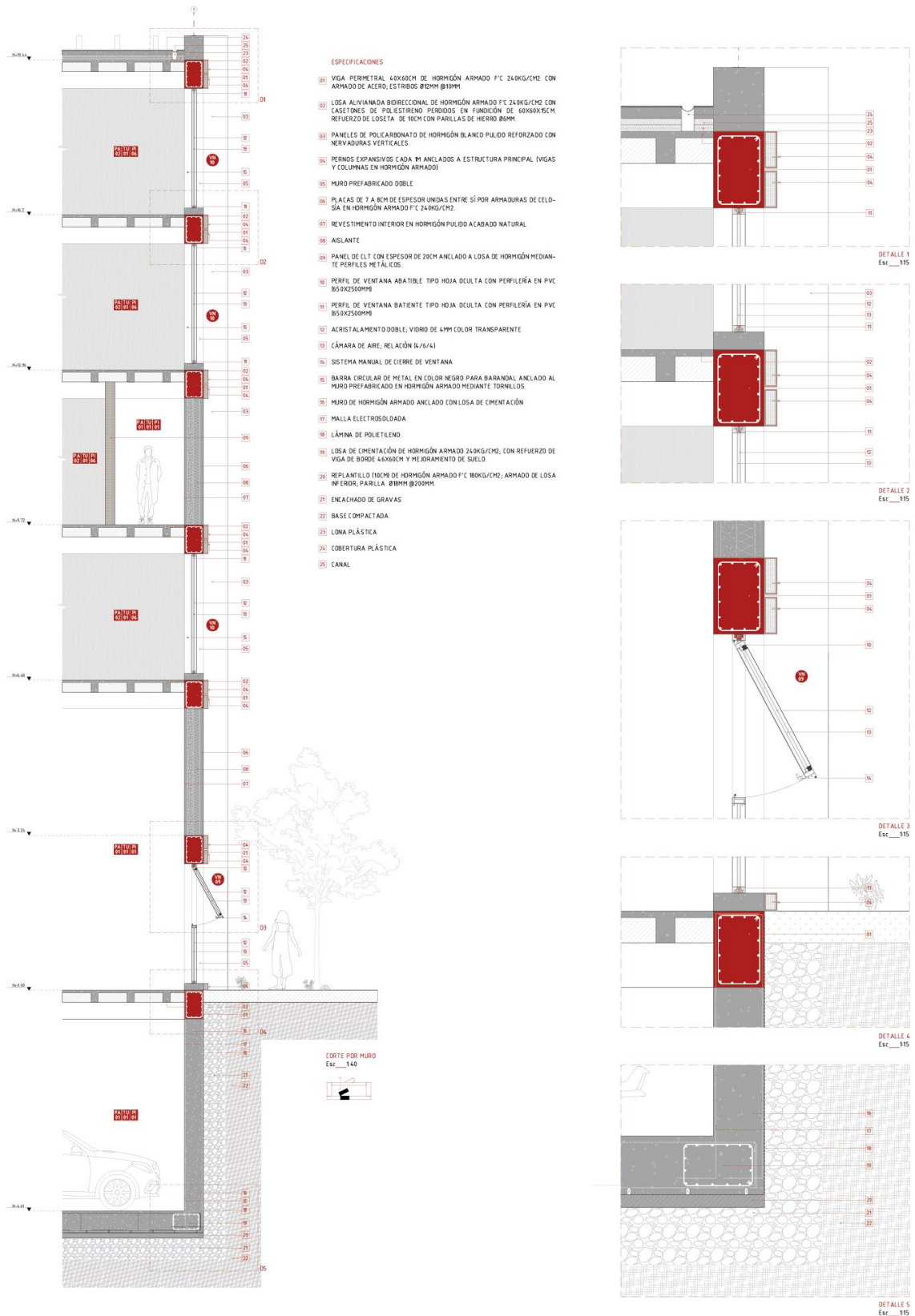
Ilustración 71: Corte por muro
