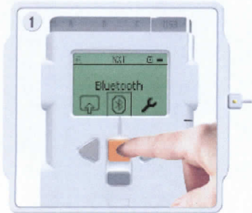
Gráfico 3.58 Instrucciones conexión Bluetooth con un ordenador
