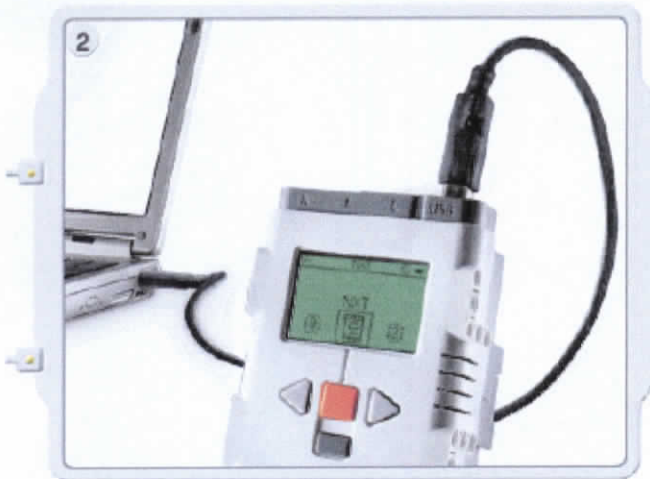
Gráfico 3.17 Instrucciones conexión utilizando cable USB
