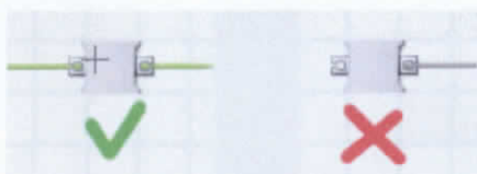
Gráfico 3.128 Tomas de entrada y salida de los cables de datos
