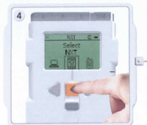
Gráfico 3.76 Instrucciones conexión de su NXT a otro NXT
