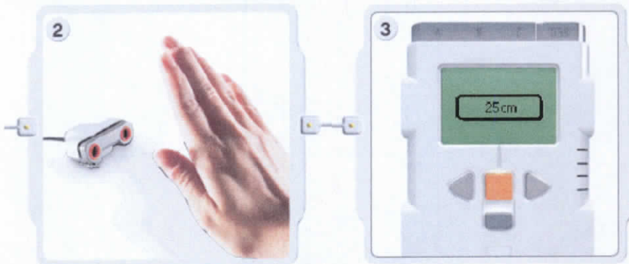
Gráfico 3.50 Instrucciones opción ver con sensor ultrasónico
