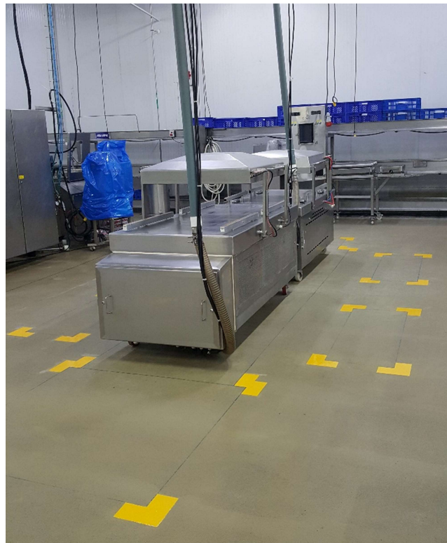
Figura 50: Campanas de vacío delimitado el piso
