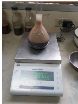
Imagen 2. Determinación del G_s , según la norma ASTM D-854
