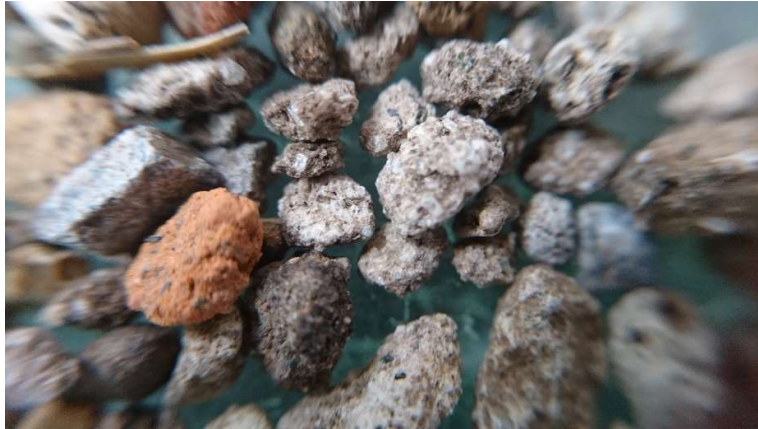
Imagen 11. Material retenido en el tamiz 2mm (#10)
