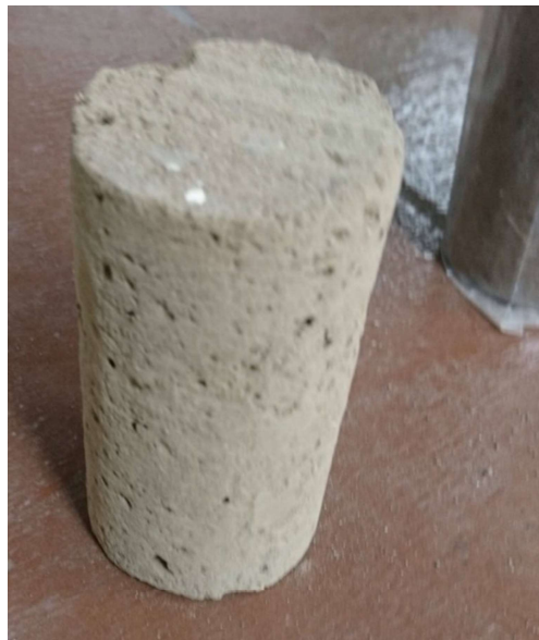
Imagen 7. Probeta tallada lista para ser ensayos triaxiales U-U.
