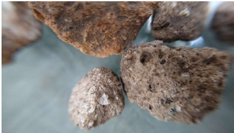
Imagen 10. Material retenido en el tamiz 4.75mm (#4)
