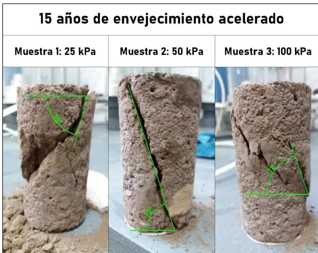
Imagen 17. Ángulos de falla - Ensayo triaxial - 15 años de envejecimiento acelerado
