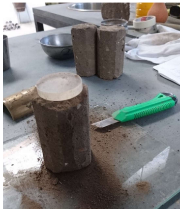
Imagen 6. Tallado de las muestras para ensayos triaxiales U-U.
