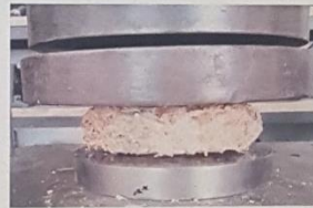
Figura 6. Esquema de ensayo de Compresión. Probeta de Caña y Tamo
