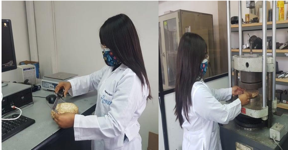
Figura 9. Análisis de la resistencia a la compresión de los biomateriales Fuente: Pérez, 2021
