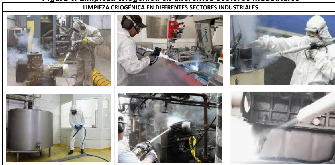
Figura 3. Limpieza criogénica en diferentes sectores industriales
