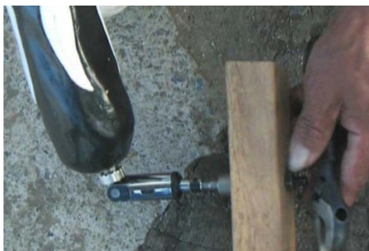
(Img. 23) Herramienta para el aumento de la superficie de contacto en tornillos y pernos.
