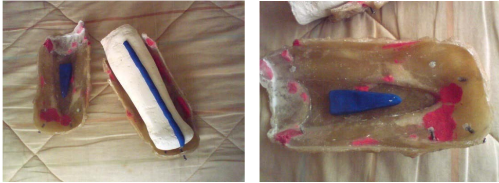
(Img. 18) Posición espacial del molde inicial en el contra molde de yeso terminado.
