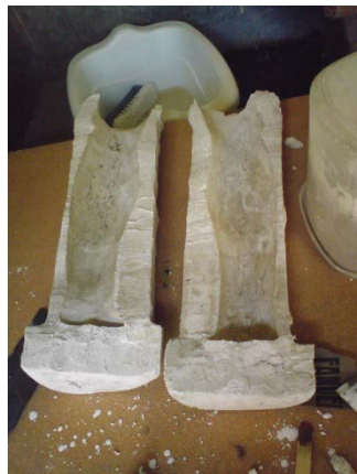
(Img. 14) Toma del molde de yeso útil para replicas.
