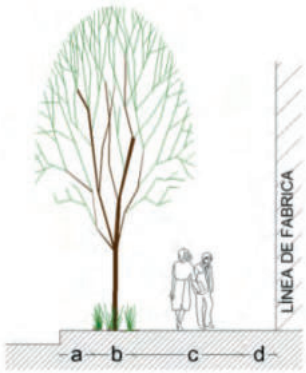
Figura 45. Esquema de acera con dimensiones mínimas.
