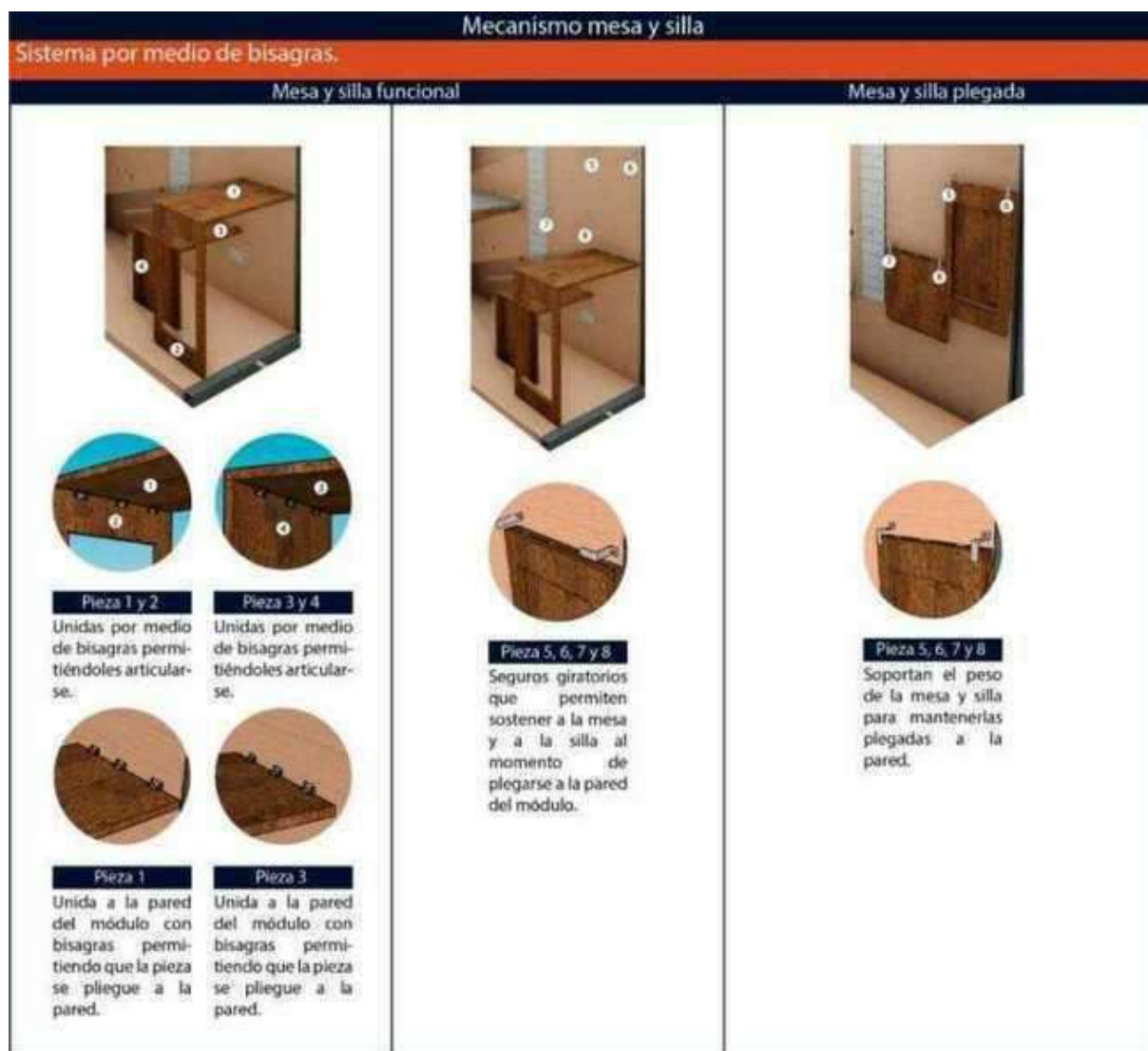
Figura 45: Mecanismo mesa y silla
