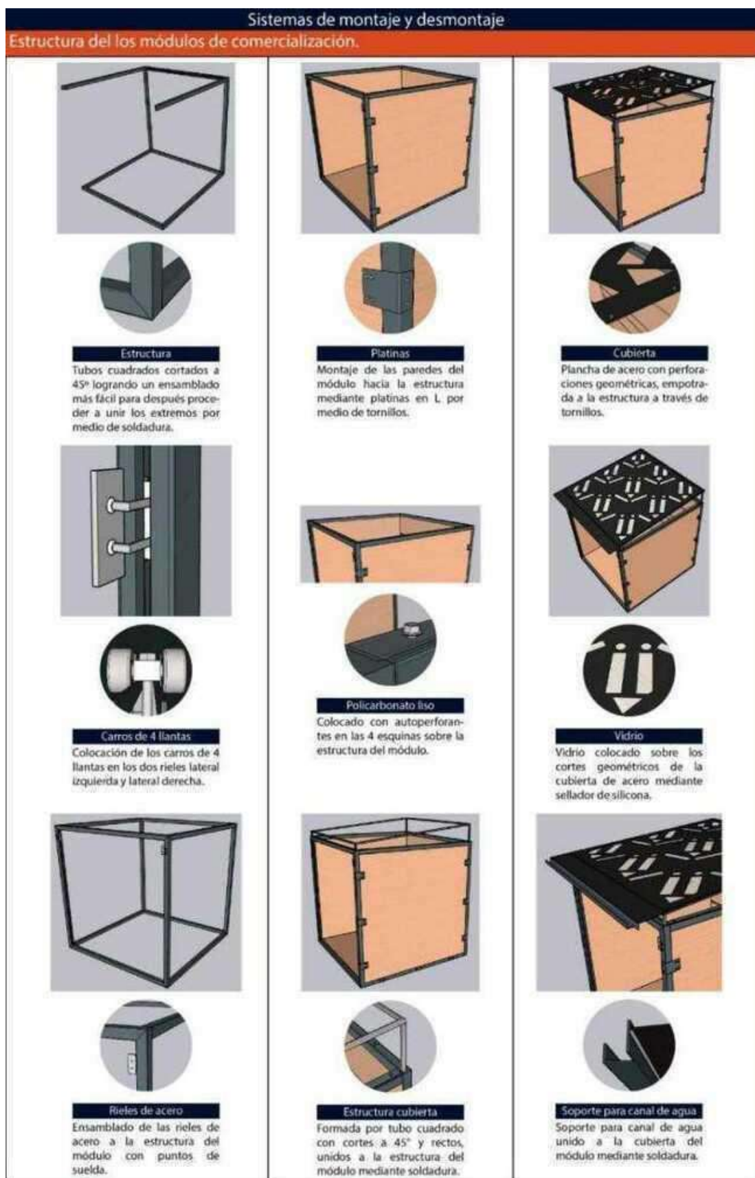
Figura 47: Sistemas de montaje y desmontaje de la estructura del módulo
