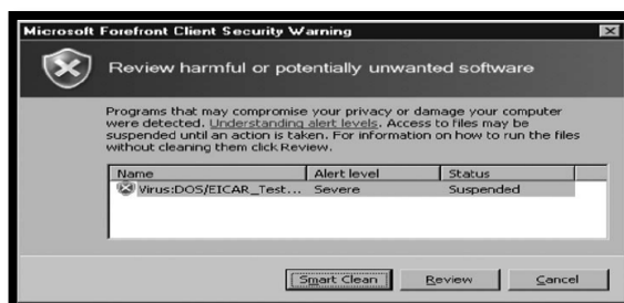
Figura 63: Tecnología Smart Clean detectando un archivo infectado con el virus de prueba EICAR. Smart Clean permite seleccionar una acción.
