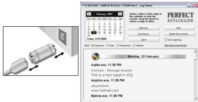
Figura 9: Keylogger Físico y mediante software. Curso de seguridad informática ESET. Fuente: http://www.eset-la.com/centro-amenazas/educacion.php
