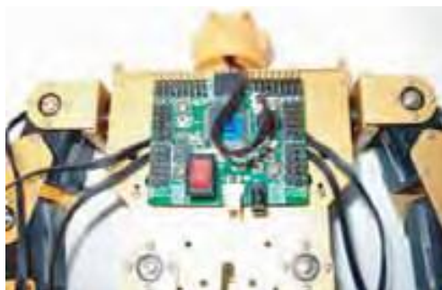
Figura 3.106 Como colocar el controlador en el robot
