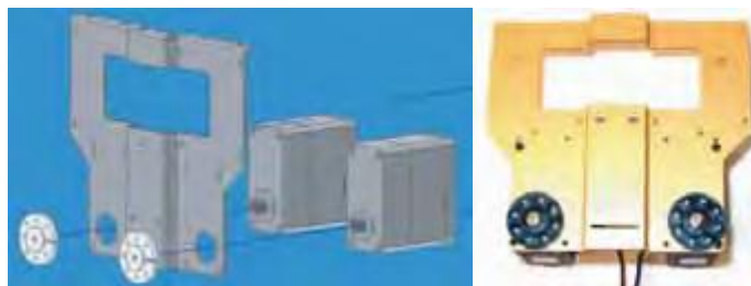
Figura 3.81 Como montar los servos de la cadera a la pletina
