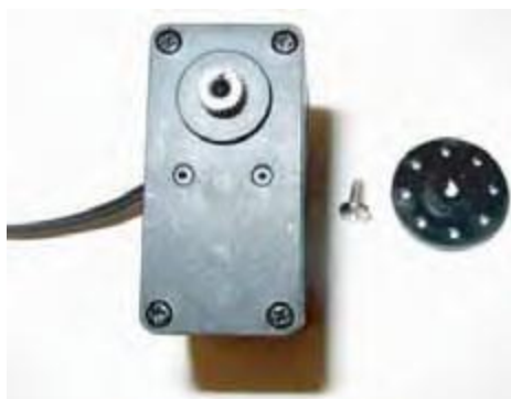
Figura 3.46 Horn con muesca numerado separado del servo
