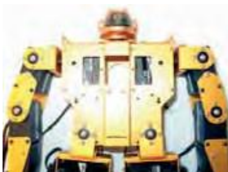
Figura 3.101 Colocación de la tapa frontal
