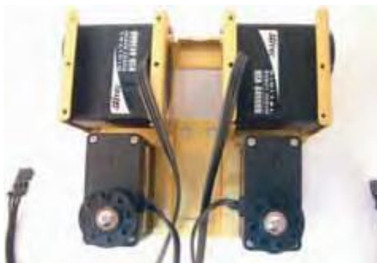
Figura 3.83 Hombros y caderas montados cables ubicados bien
