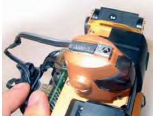
Figura 3.114 Sensor IR instalado en el Robonova-1
