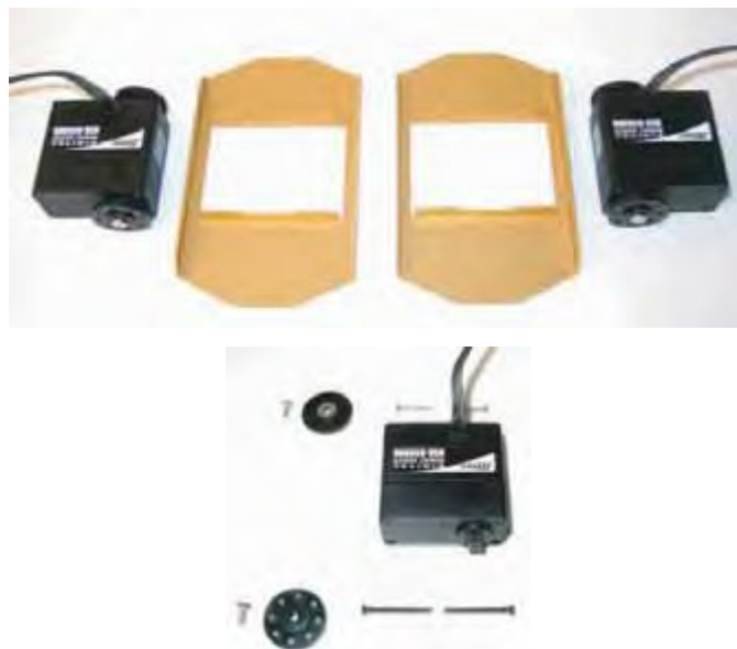
Figura 3.51 Montaje de los pies
