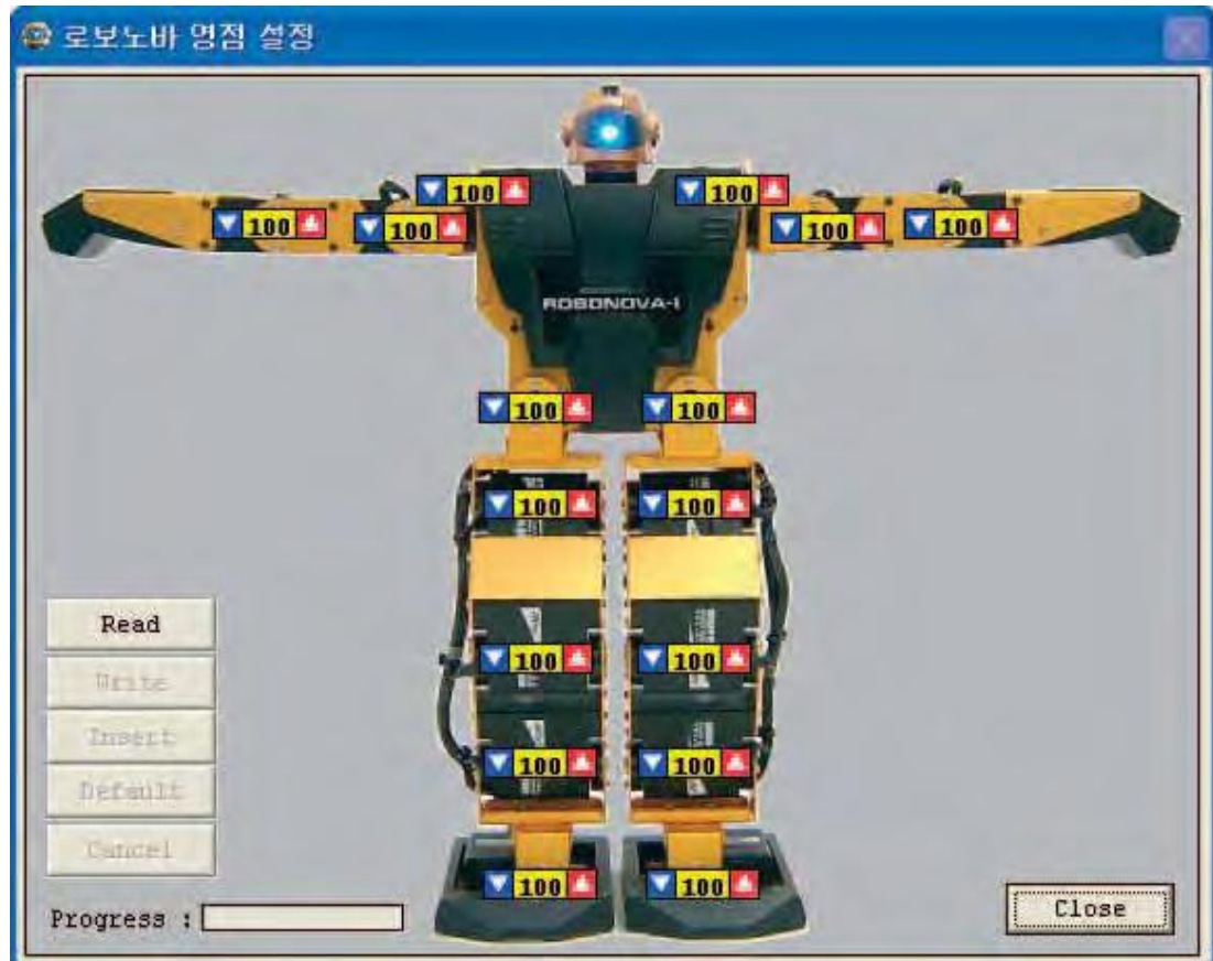
Figura 4.125 Ventana de la imagen del ROBONOVA en posición con sus puntos neutros
