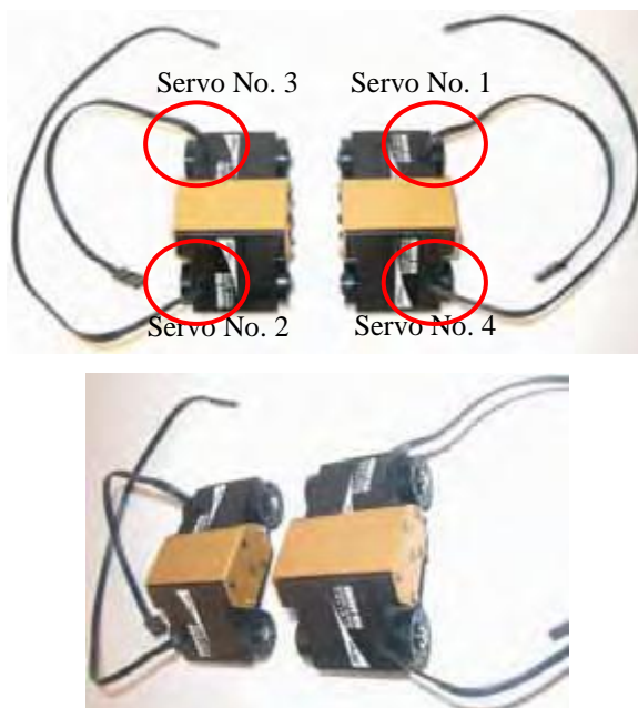
Figura 3.65 Forma correcta del montaje de las rodillas
