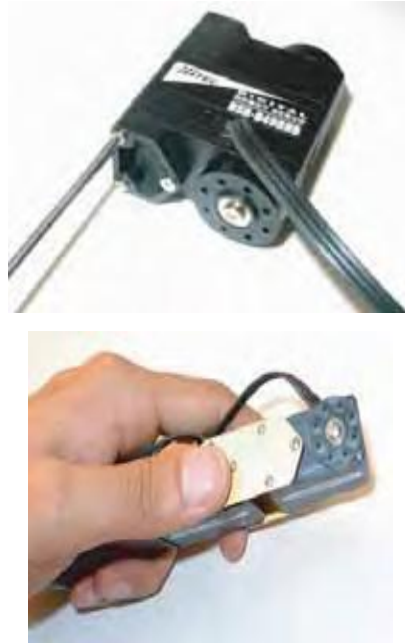
Figura 3.50 Forma de unir la pletina con el servo
