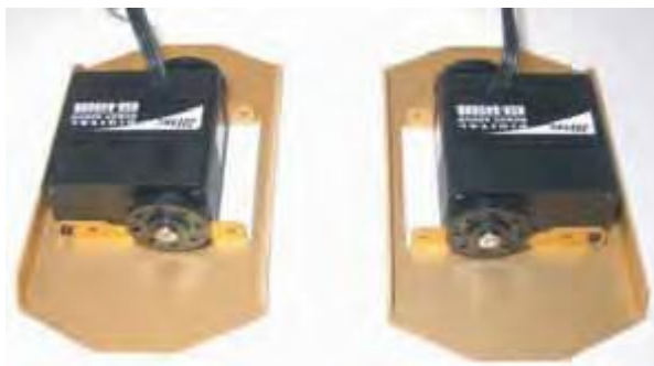
Figura 3.54 Montaje finalizado de los pies
