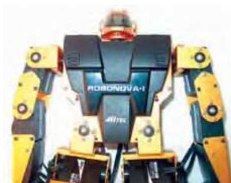
Figura 3.104 Tapa frontal ya instalada
