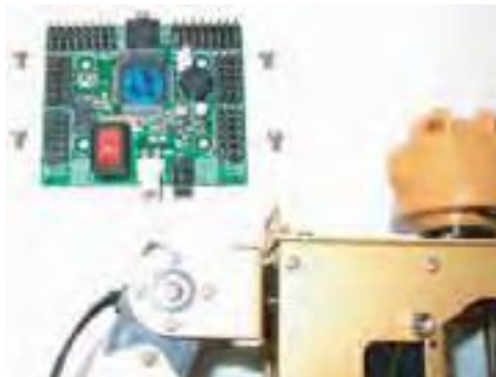
Figura 3.105 Colocación del controlador MR-C3024
