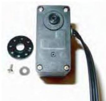
Figura 3.48 Horn libre separado del servo
