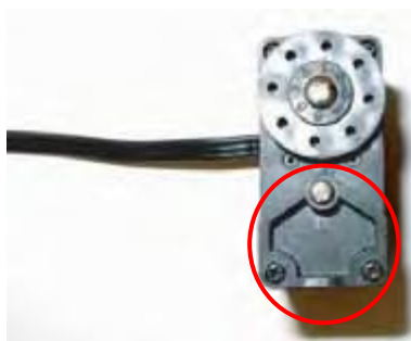
Figura 3.49 Forma pentagonal del servo
