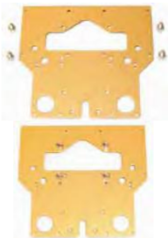
Figura 3.84 Montaje de la parte trasera de la cadera
