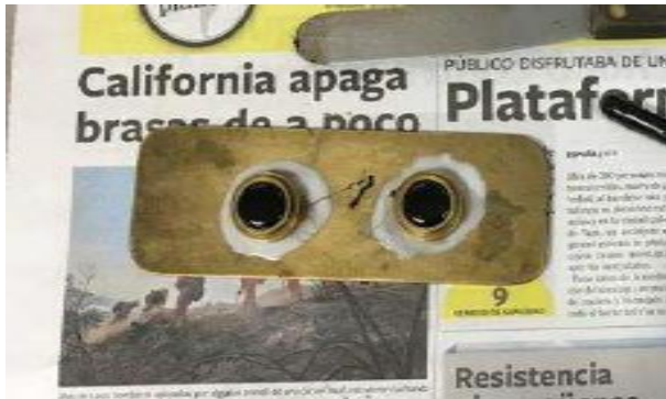
Imagen 3.9. Briquetas para el ensayo de punto de ablandamiento.
