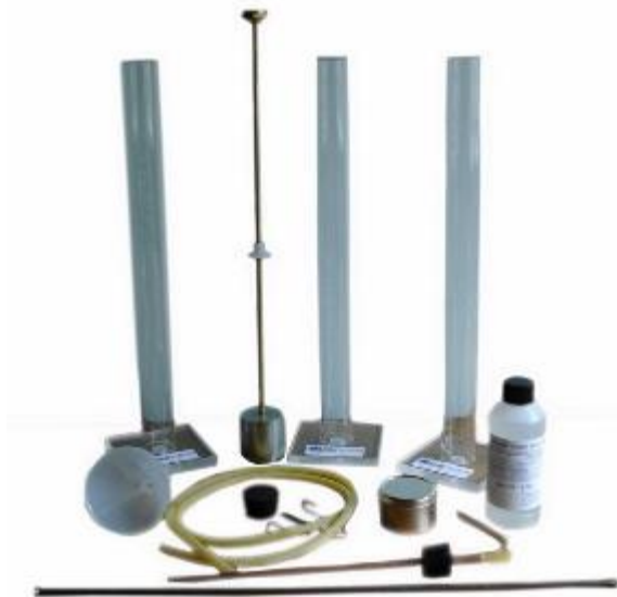
Imagen 3.1. Equipo ensayo contenido de arena.
