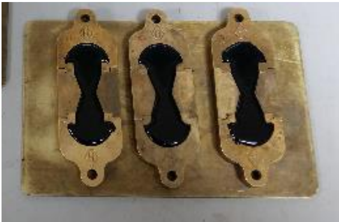
Imagen 3.12. Briquetas estándar para el ensayo de ductilidad.
