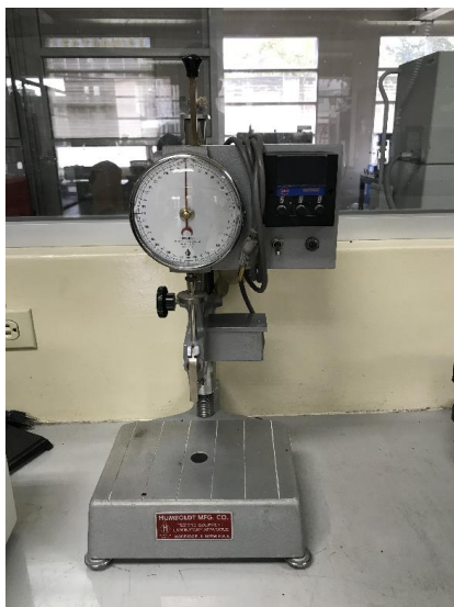
Imagen 3.8. Equipo para el ensayo de penetración.
