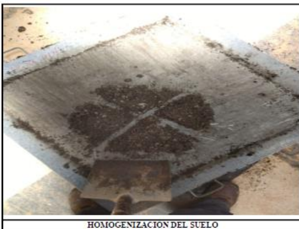
HOMOGENIZACION DEL SUELO
