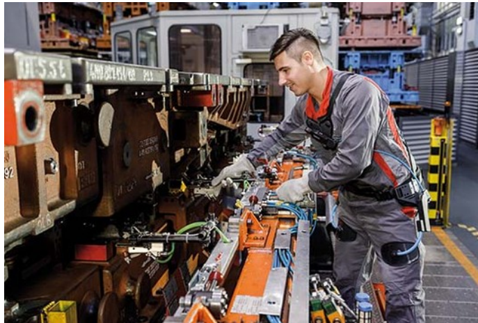
Figura 6. AUDI El fabricante de automóviles alemán dice que los trajes son capaces de proporcionar soporte físico a los trabajadores de las fábricas. Extraído de (Kirby, 2017)
