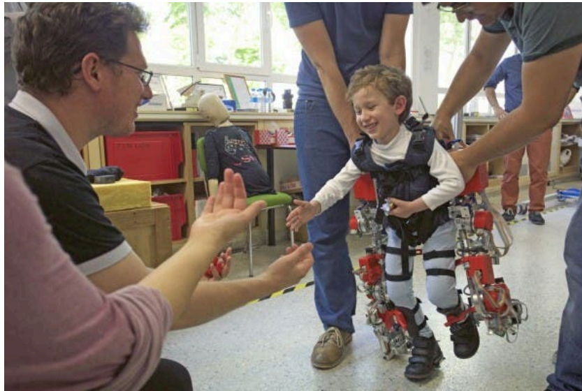
Figura 2. Exoesqueleto para la marcha humana en un infante, extraído de (Gutman, 2016).
