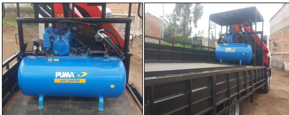
Figura 2. Compresor; equipo para la realización de traspase de químicos
