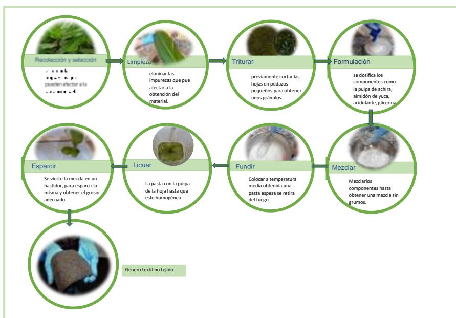
Figura 7. Proceso de obtención de un no tejido
