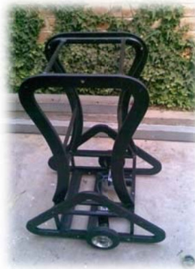
Ilustración 10: Esqueleto de la base móvil
