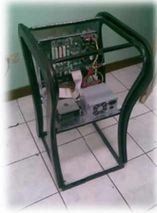
Ilustración 11: Computador ensamblado en la parte superior de la base
