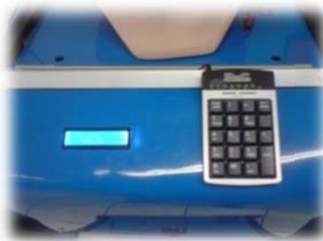
Ilustración 16: Teclado de control y display LCD montados en la base móvil
