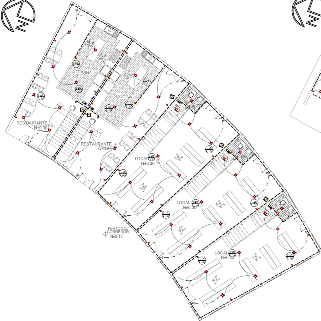
BLOQUE 1 ALAUSI INSTALACIONES HIDROSANITARIAS PLANTA BAJA ESC: 1:200
