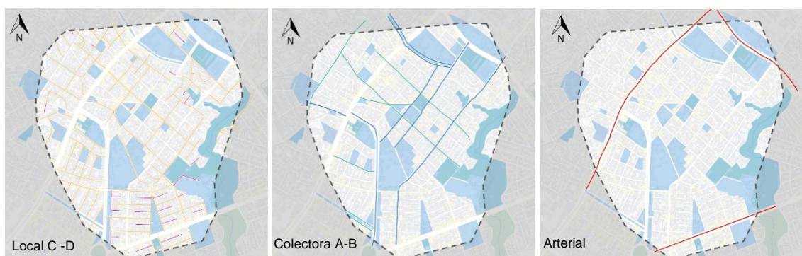
Figura 28 Plano del área del caso de estudio – Desglose de la jerarquización vial
