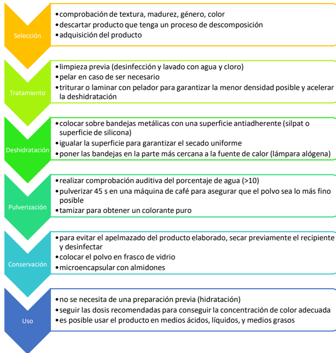
Ilustración 21 – Resumen: procedimiento de extracción del colorante. (Colina, 2025)
