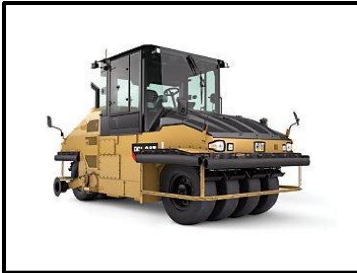
Ilustración 35: Medida preventiva de control de ingeniería operador de rodillo neumático
