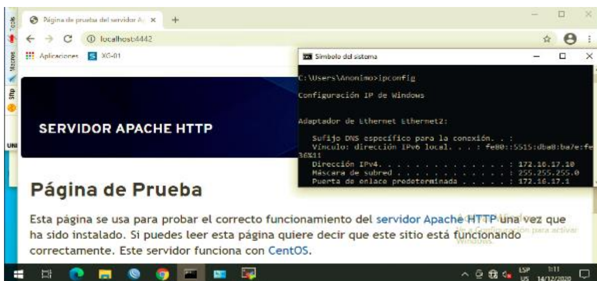
Figura 54. Conexión exitosa a un equipo no autorizado mediante túnel SSH
