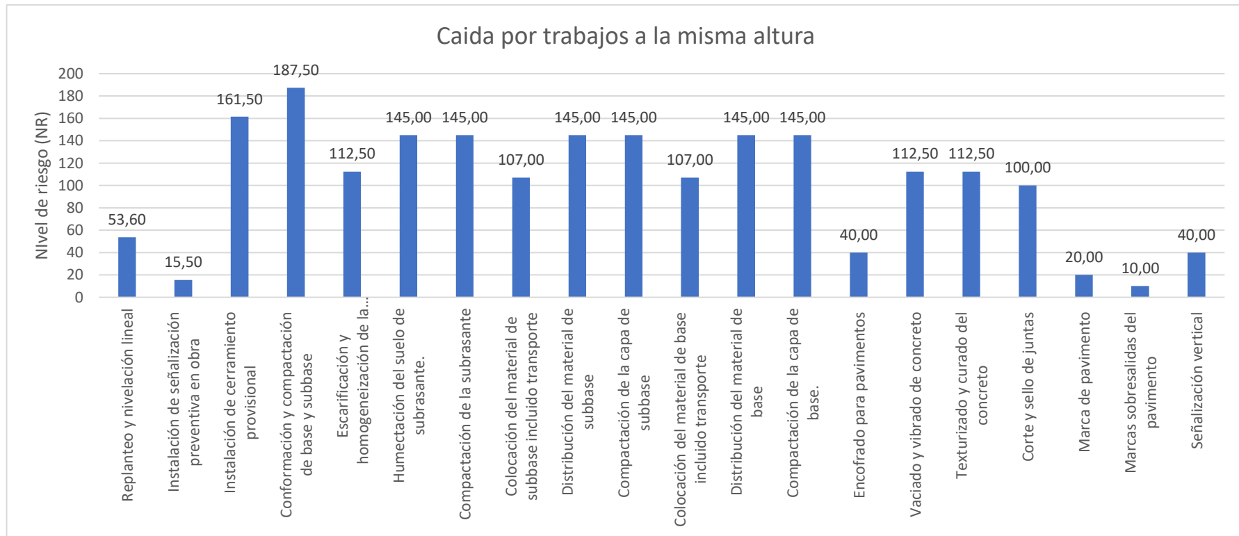
Ilustración 12 Nivel de Riesgo de Caída por trabajos a la misma altura en los Procesos Constructivos (Autoría Propia)
