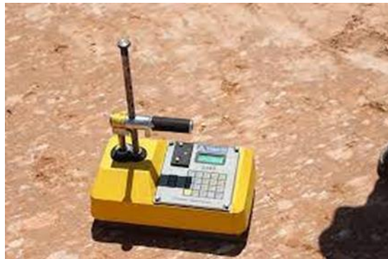
Ilustración 2 Densímetro nuclear en campo (Autoría Propia)
