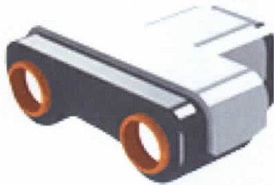
Figura 13. Sensor de Ultrasonido del kit Lego Mindstorm NXT
