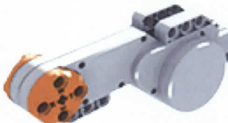
Figura 17. Servomotor del kit Lego Mindstorm NXT
