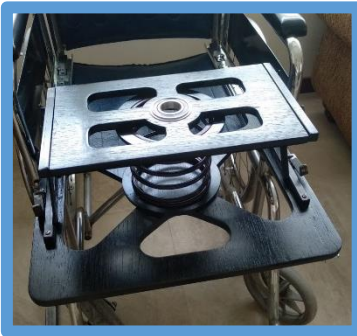
Gráfico 52: pieza para el desplazamiento y levantamiento del accesorio
