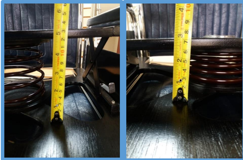
Gráfico 55: medidas del sistema de levantamiento
