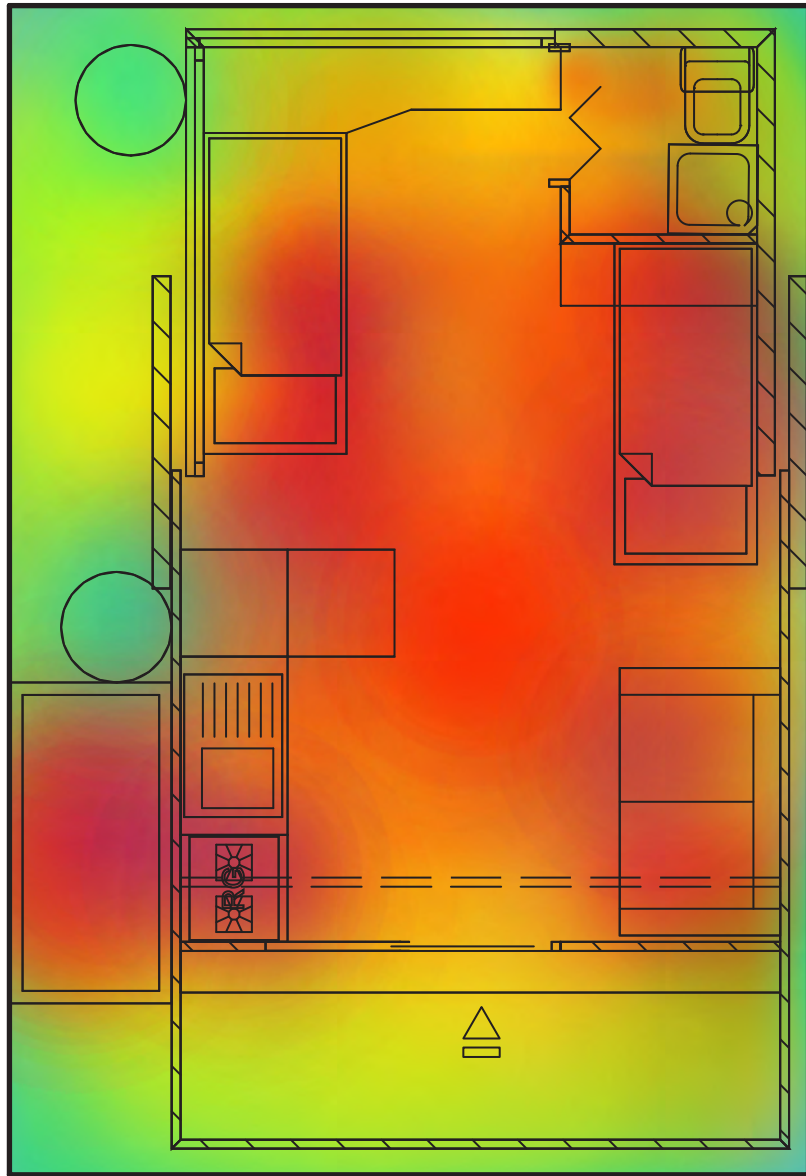
Espectro Termico Interior por medición de Lumines y calor corporal determinado por Software : Polaris 2
