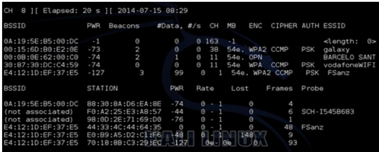
Figura 22 Visualización del ESSID llamado FSanz
