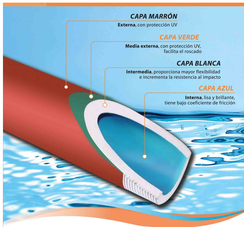
(Fig. 05) Capas internas de cuatritubo en PVC
