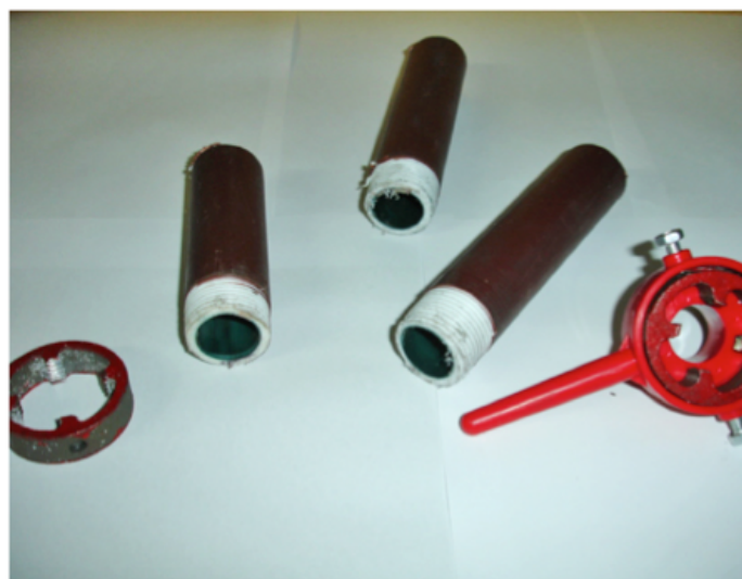
(Img. 19) Roscado de tubos en PVC
