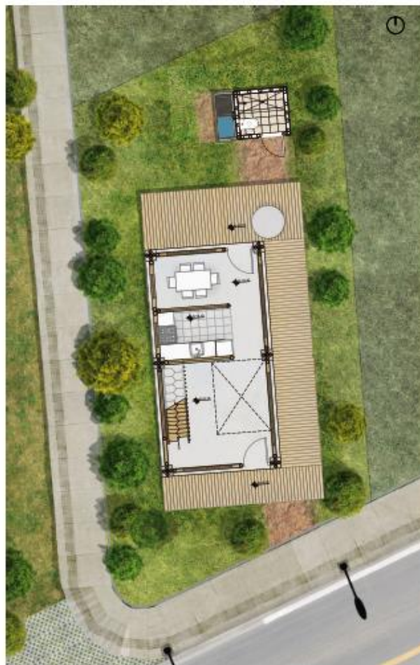
Figura 69: Baño ubicado en el exterior - planta
