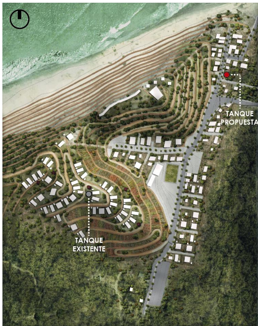
Figura 44: Ubicación tanque existente y tanque nuevo
