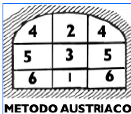
Figura No. 59 Método Austriaco. (CHILE, 2007) 16
