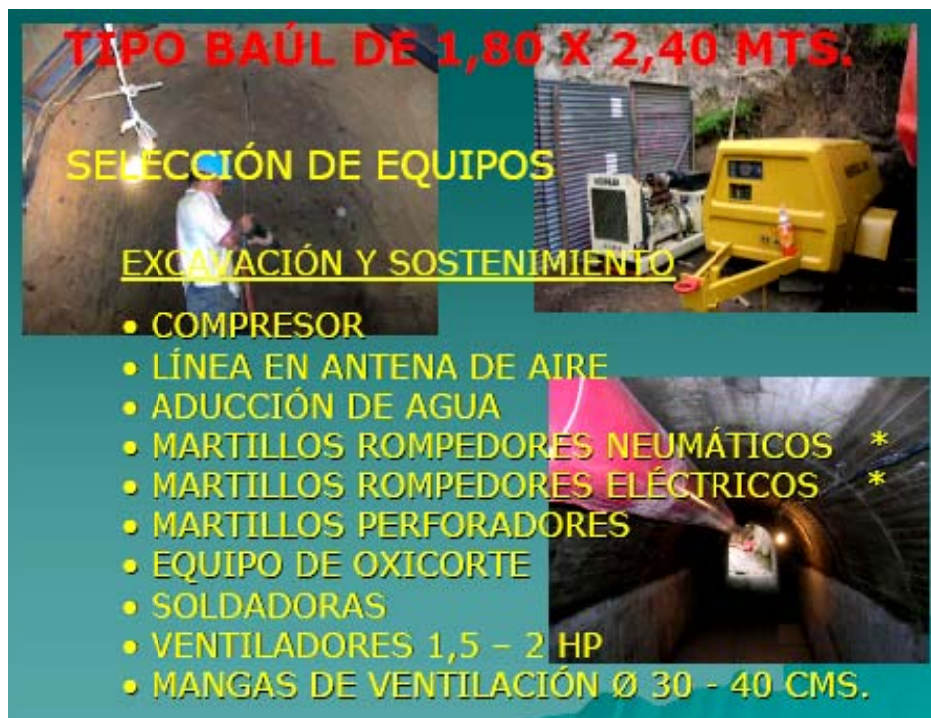
Figura No. 82 Tipo Baúl 1.80m. x 2.40m. Equipos de excavación y sostenimiento. (AIME & GEOCONSULT, 2006) 131
