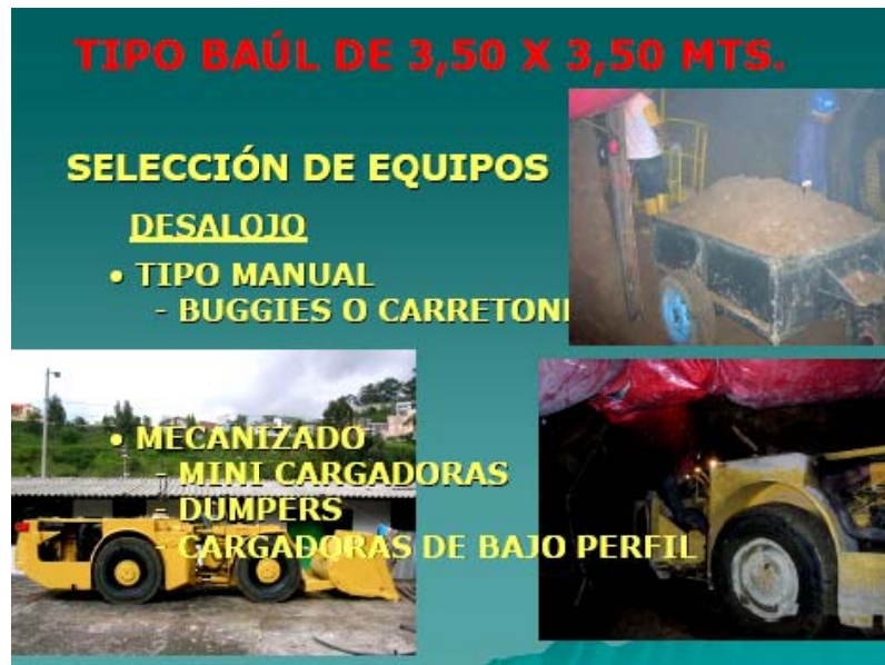
Figura No. 85 Tipo Baúl 3.50m. x 3.50m. Desalojo de materiales. (AIME & GEOCONSULT, 2006) 133
