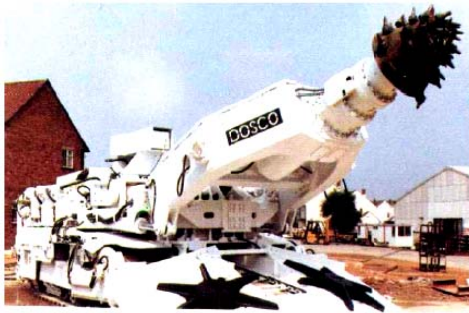
Figura No. 76 Rozadoras. Inicialmente diseñado para el área de Extracción de mineral de Carbón y suelo blando, fue posteriormente ampliado para uso en rocas más duras. (GALERA, 2008). 127
