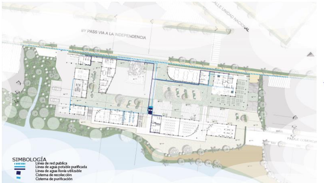
Gráfico 40: Red de distribución en el proyecto (CIFA, Centro de Investigación y Formación Agraria, Heriberto Cáceres, 2015)
