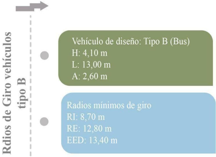
Figura 35 Características dimensionales y radios mínimos de giro del vehículo de diseño tipo B.
