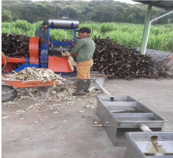
Figura 19. Proceso de filtrado del jugo de caña
