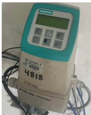
Figura 10. Transmisor electromagnético Siemens.
