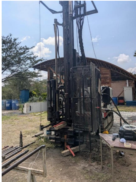
FOTOGRAFÍA 5. PERFORADORA BOART LONGYEAR Y EQUIPOS DE PERFORACIÓN A DIAMANTINA (SEBASTIAN, 2025).
