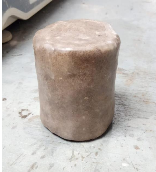
FOTOGRAFÍA 4. ENSAYO DE DENSIDAD NATURAL EN LABORATORIO (SEBASTIAN, 2025).
