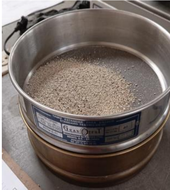
FOTOGRAFÍA 2. ENSAYO DE GRANULOMETRÍA POR TAMIZADO (SEBASTIAN, 2025).
