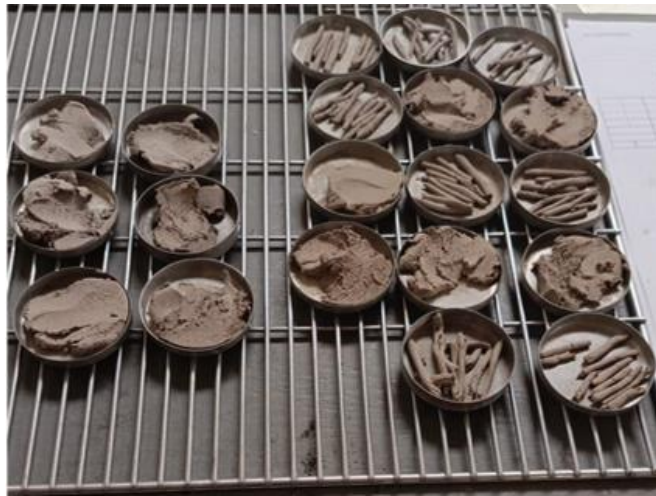
FOTOGRAFÍA 1. ENSAYO DE LÍMITE LÍQUIDO Y LÍMITE PLÁSTICO (SEBASTIAN, 2025).
