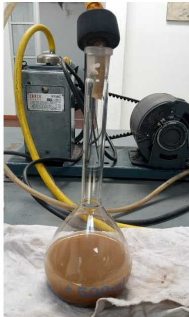
FOTOGRAFÍA 3. ENSAYO DE GRAVEDAD ESPECÍFICA (SEBASTIAN, 2025)
