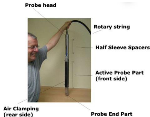
ILUSTRACIÓN 8. ESQUEMA DEL EQUIPO EMISOR DE ONDAS (P) Y (S) (GMBH, 2023).
