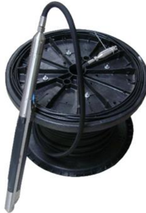
ILUSTRACIÓN 7. EQUIPO GENERADOR DE ONDAS (P) Y (S) (GMBH, 2023).
