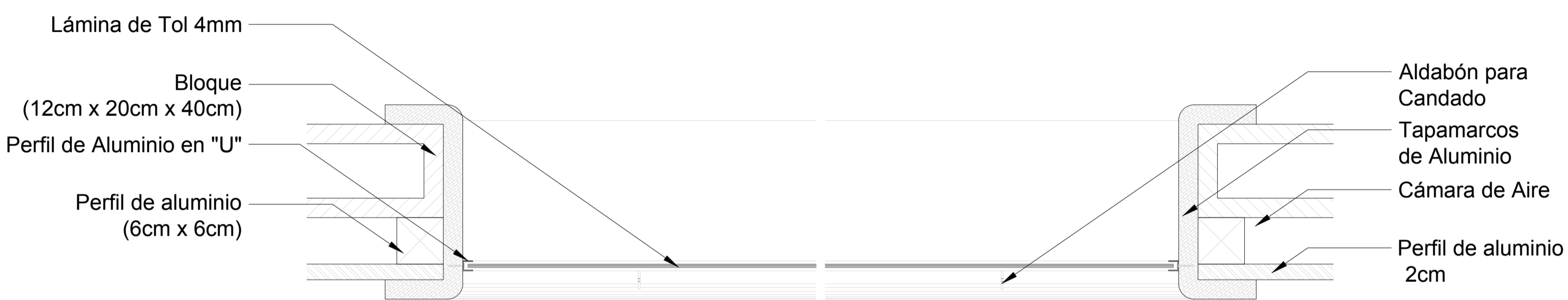
DETALLE DE VENTANA 4 ESC 1:5
