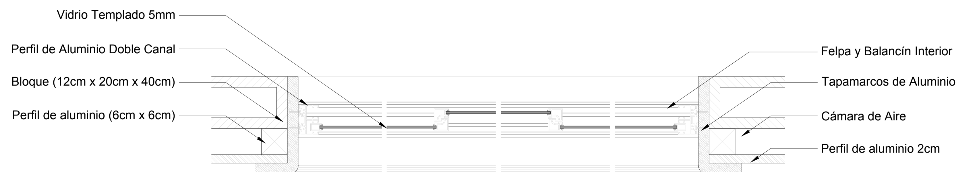
DETALLE DE VENTANA 2 ESC 1:5
