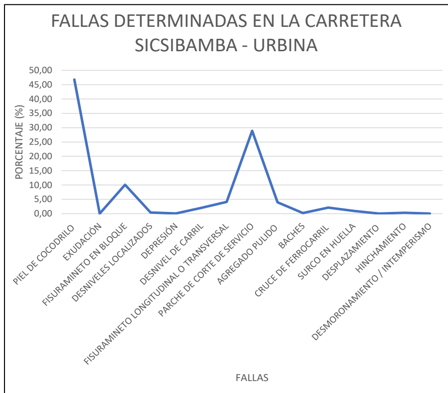
Ilustración 35: Fallas determinadas en la carretera Sicsibamba – Urbina – Elaboración Propia
