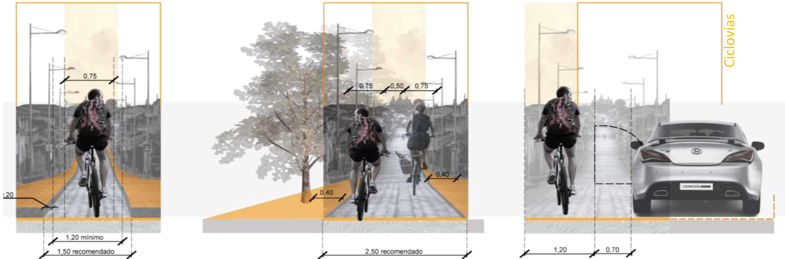
Figura 27 Dimensionamiento de ciclovías según "INEN"
