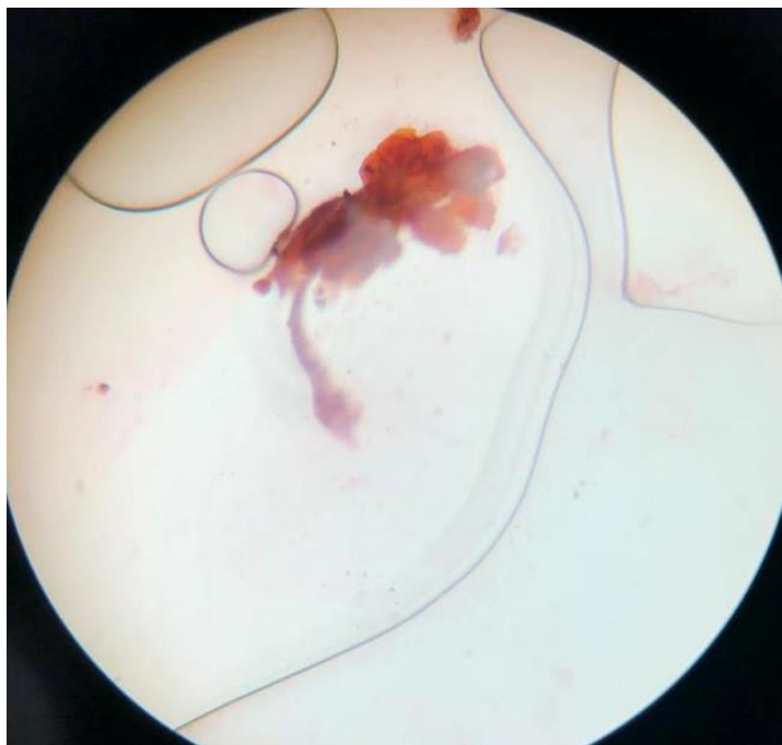
Figura 13. Bacterias formando un film con el cobre recuperado, visto a través de un microscopio con aumento de 40X Fuente: Arcos, C. 2019.
