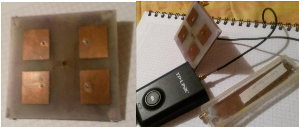
Figura 24. Fabricación del Arreglo Microstrip Fuente: Autor
