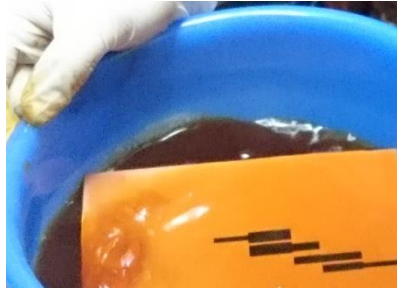
Figura 17. Placa de cobre dentro del ácido Fuente: Autor
