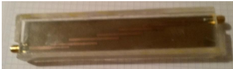
Figura 18. Fabricación del Filtro Chebyshev Optimizado con Líneas de Microstrip Fuente: Autor
