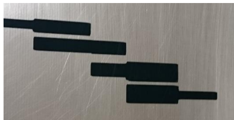
Figura 16. Diseño del Filtro sobre la Placa de Cobre a través de transferencia térmica Fuente: Autor
