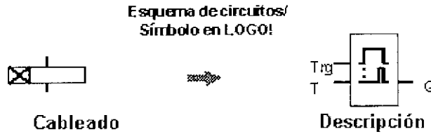
Figura 3.12 Esquema de circuito y la representación en logo de la función de retardo a la activación
