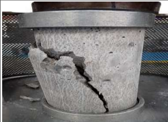
ENSAYO A COMPRESIÓN
