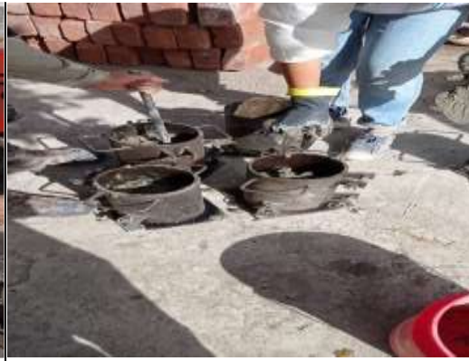
FUNDICIÓN DE CILINDROS DE HORMIGÓN
