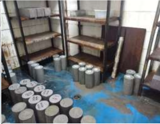
CURADO EN CÁMARA DE HUMEDAD
