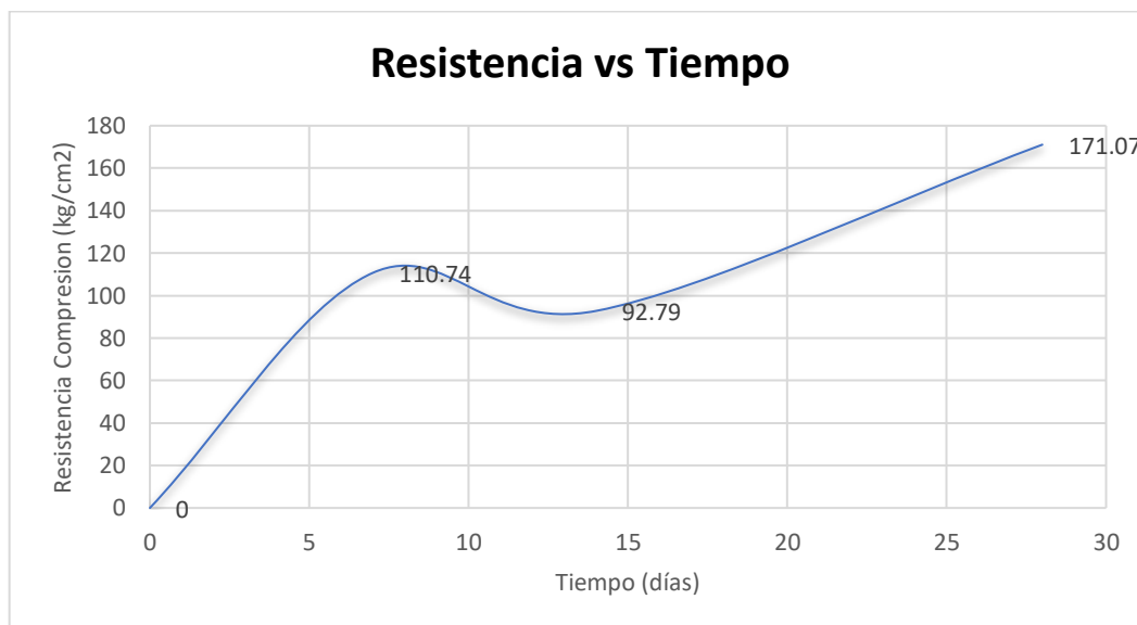
Ilustración 16 Curva de resistencia Hormigón f'c 240 con 30% a los 7 días, 14 días y 28 días.
