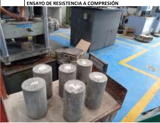
RETIRO DE LA CÁMARA DE HUMEDAD
