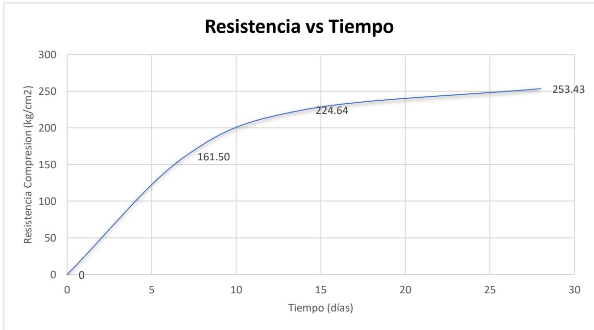
Ilustración 9 Curva de resistencia Hormigón f'c 240 a los 7 días,14 días y 28 días.
