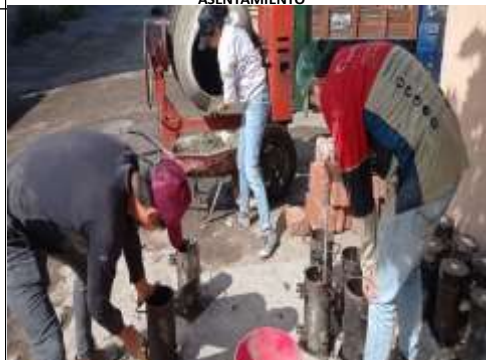
FUNDICIÓN DE CILINDROS DE HORMIGÓN
