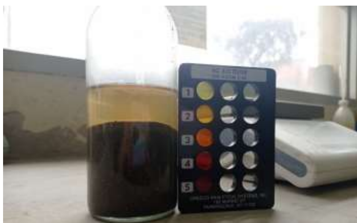
Ilustración 8 Comparación de colores por medio de una placa orgánica de colores
