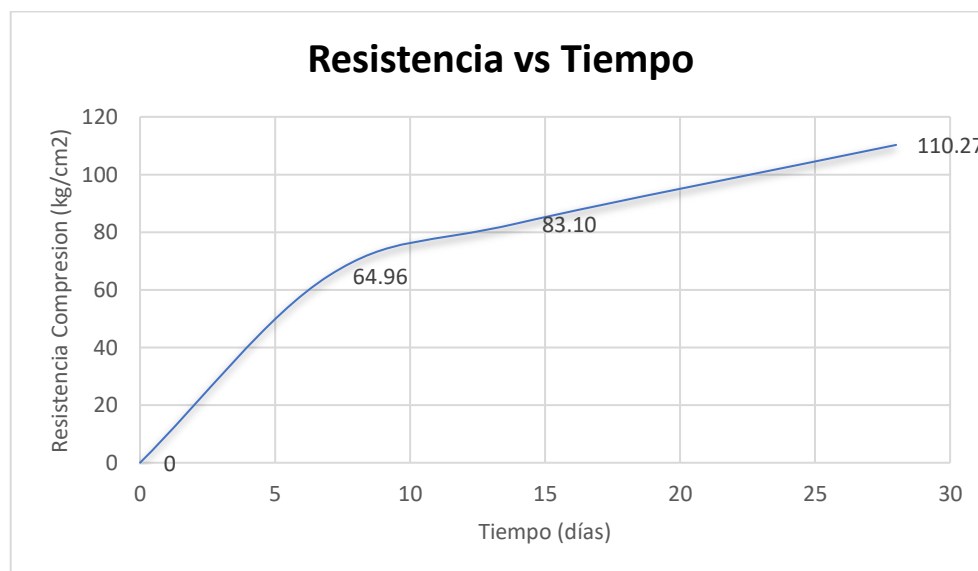
Ilustración 12 Curva de resistencia Hormigón f'c 240 con 30% a los 7 días,14 días y 28 días.
