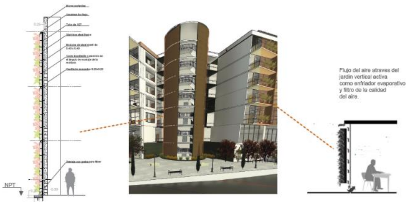
Gráfica, Detalle Muros Verdes y Acústica Proyecto
