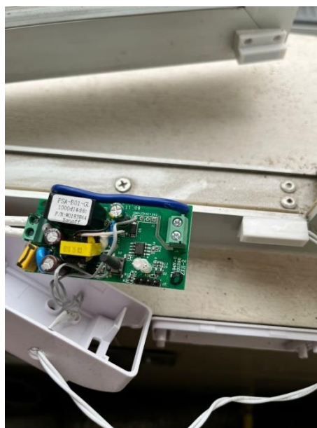
Figura 58: Conexión a GND del sensor de ventana.
