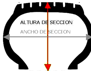
Imagen 25: Altura de Sección
