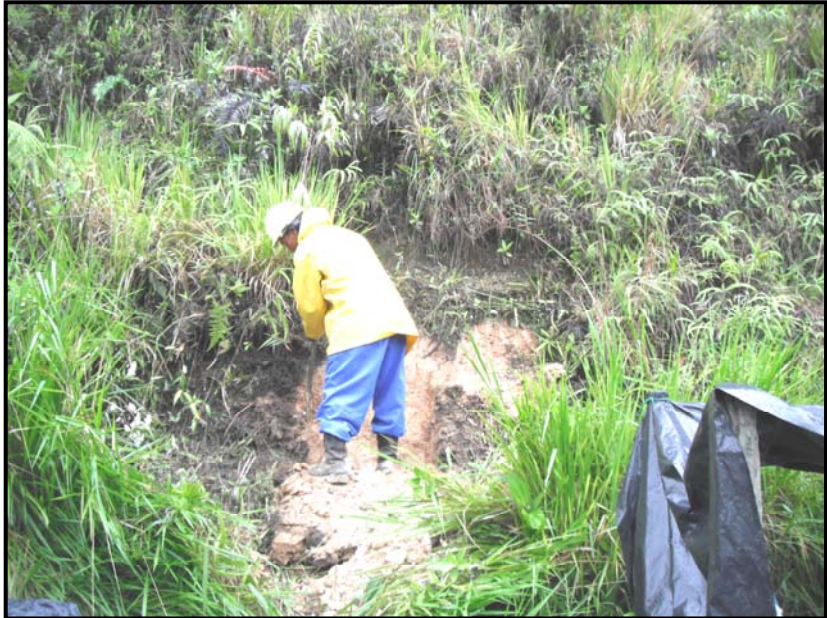
FOTO No. 2.- Extracción de muestra inalterada tipo bloque. Sondeo LZ17-P2
